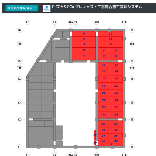
図-4 施工情報入力画面(取付予定日)
