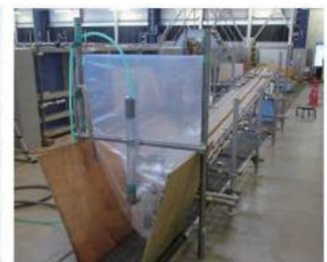
図-15 シート内不織布透水試験設備
