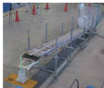
図-15 シート内不織布透水試験設備
