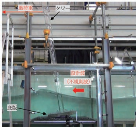
写真-1 安定性実験状況 (ケース1, 風荷重 29 N, 転倒時)
