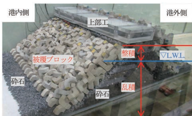
写真-1 防波堤模型設置状況
