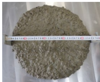
写真-2 スランプフロー(加振後)
