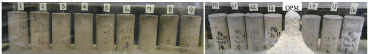
写真-3 浸漬期間 28 日における供試体の硫酸浸食状況
