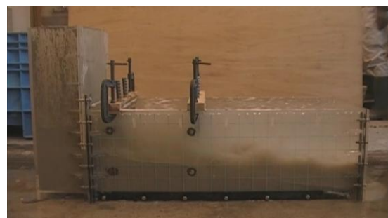
水中流動状況 SW-SS(障害有り)
