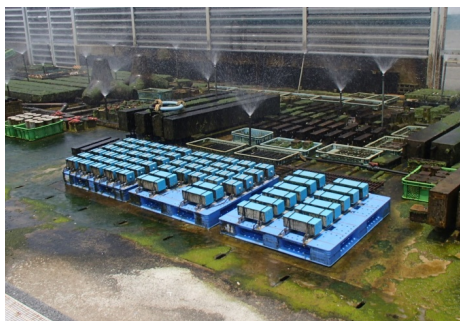
図-1 海水シャワー曝露試験状況
