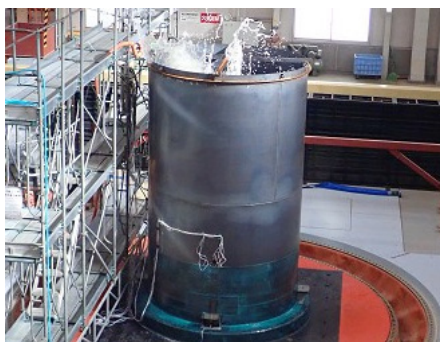
写真-1 実験状況(例:スロッシング)
