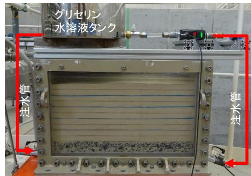
図-7 遠心模実験模型および実験装置
