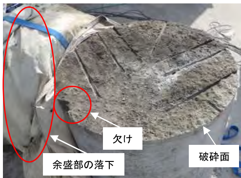
写真-1 破断予定ラインを水平に設定した場合の破断状況
