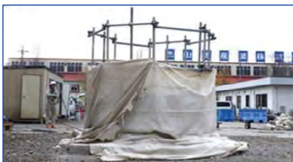
写真-3 水平破断前の試験体 （防爆養生・ずれ防止）
