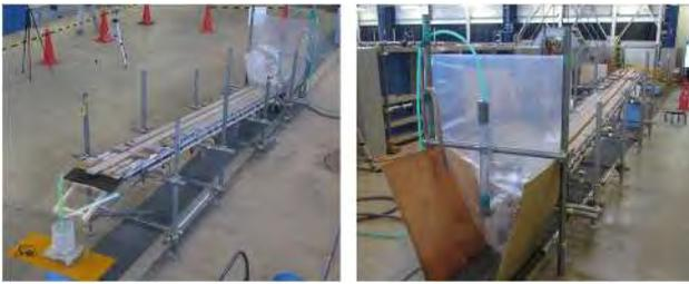
図-15 シート内不織布透水試験設備
