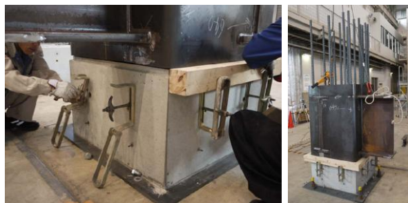
写真一8 角材受けによる倒れ止め
