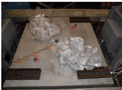
写真-13 7回目の積載物の配置状況
