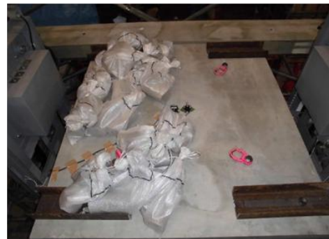
写真-14 9回目の積載物の配置状況
