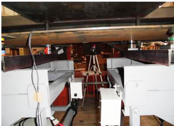
写真-3 駆動部架台・ロードセル取付け状況
