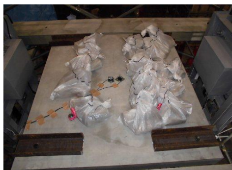
写真-12 5回目の積載物の配置状況
