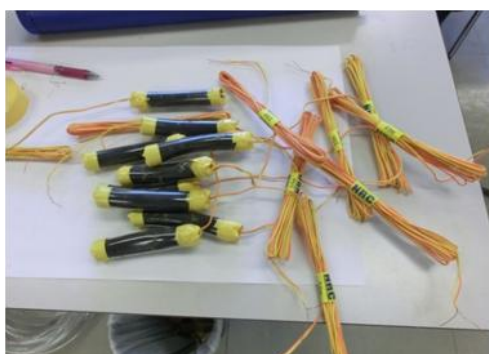
写真-15 破砕ライン形成用 NRC 装薬状態(各管 25g)
