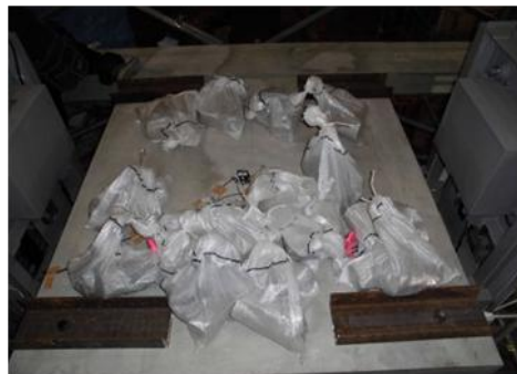
写真-11 3回目の積載物の配置状況
