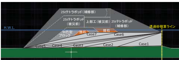
図-3 被災傾斜堤断面のモデル化
