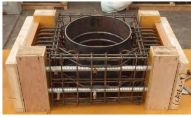
写真-1 杭頭部材製作
