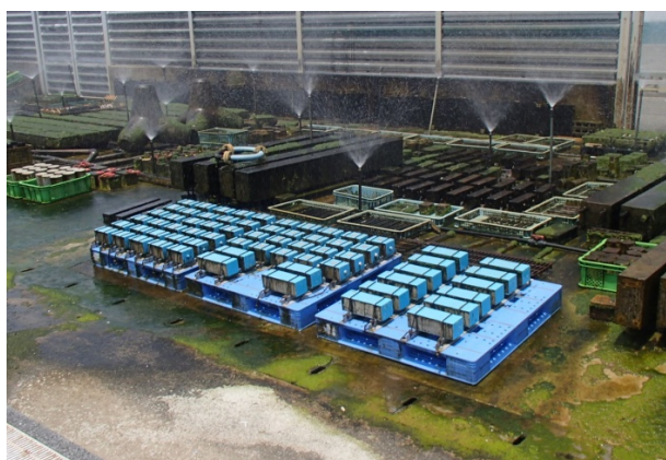
図-1 海水シャワー曝露試験状況
