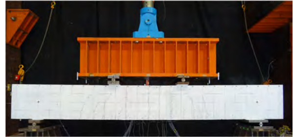
写真-3 曲げ載荷実験の状況
