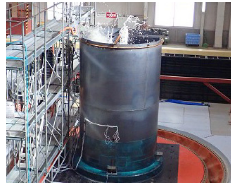
写真-1 実験状況 (例: スロッシング)
