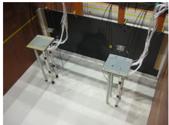
(c) 非液状化地盤作製完了 (杭基礎周辺)
