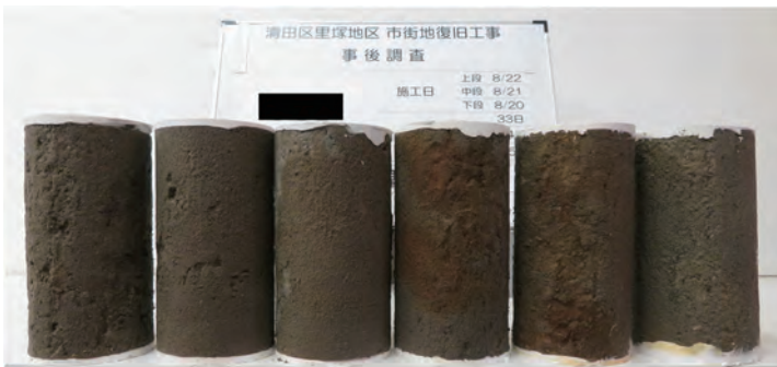
図 21 事後調査で実施した一軸圧縮試験の供試体の写真
