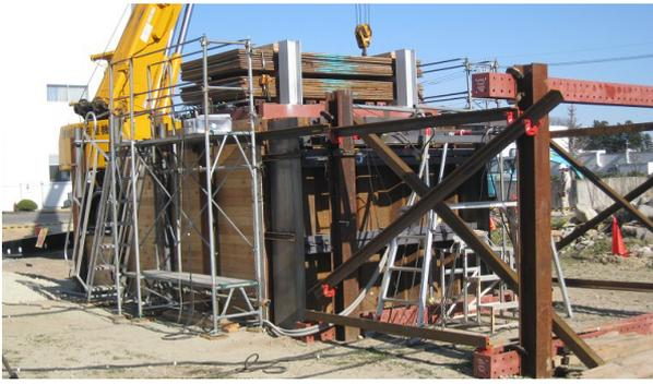
写真 4 大型模型載荷実験の状況
