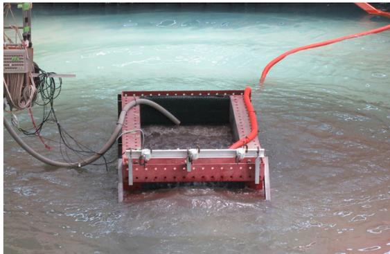
写真3 振動下の水中引抜き状況
