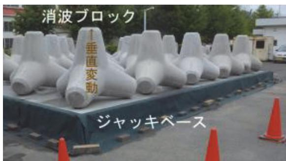
図-2 垂直変動させる消波ブロック列 (模擬港湾構造物)
