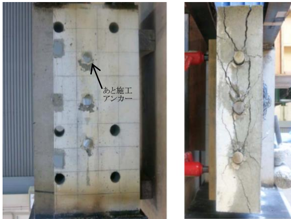
(a) 既存部 (b) 増設壁側
