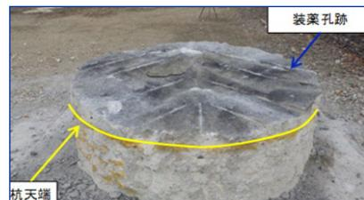
写真-5 水平破断面(天端)
