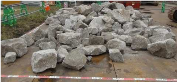
写真-1 使用した捨石(30~200kg/個,小豆島産の花崗岩)
