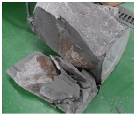
写真-6 300-1 供試体の破壊状況
