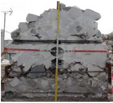
写真-5 配合 No.1 のワイヤーソーによる切断面
