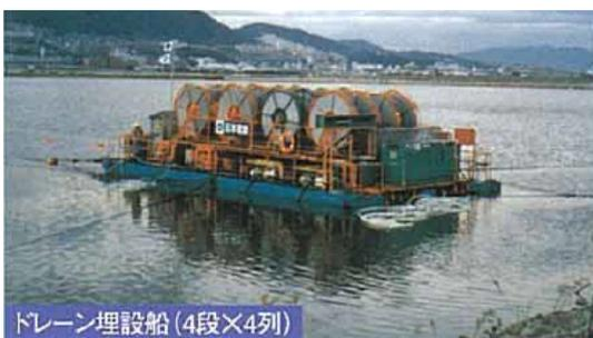
写真-7 ドレーン埋設船の全景(4 列×4 段)
