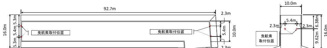
図-1 異型長大ケーソン概要図（東④）
