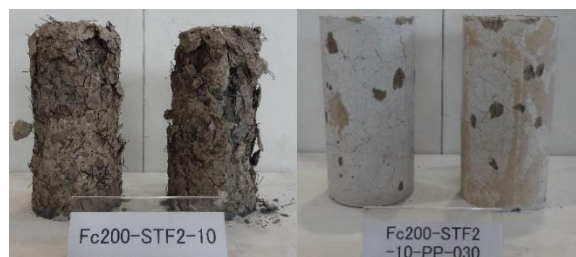
写真-1 加熱試験終了後の供試体
