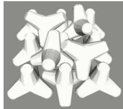
図-1 消波ブロック3次元モデル
