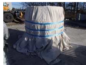
写真-16 防爆養生 (試験体 A)
