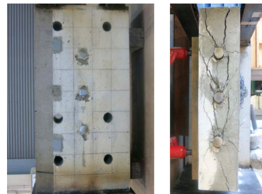
写真-5 実験終了時破壊状況
