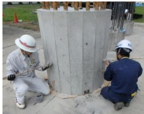
写真-17 試験体 3 (破砕前の状態)
