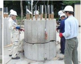
写真-8 破砕直後の 状態(試験体1)
