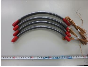
写真-16 動的破砕剤と点火具 (試験体 3)
