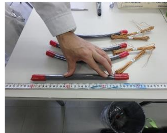
写真-21 動的破砕剤と点火具 (試験体 4)
