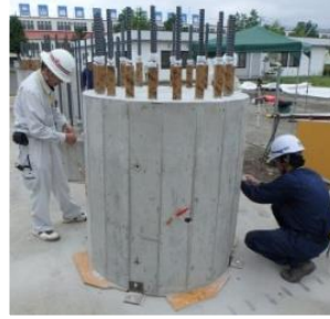
写真-12 試験体 2 (破砕前の状態)
