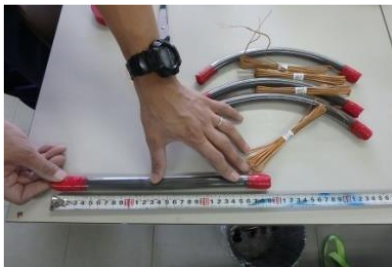
写真-11 動的破砕剤 + 点火具(試験体 2)
