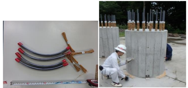
写真-3 動的破砕剤 +点火具(試験体1)
