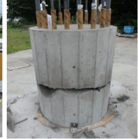
写真-13 破砕直後の状態(試験体 2)
