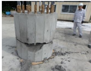
写真-18 破砕直後の 状態 (試験体 3)
