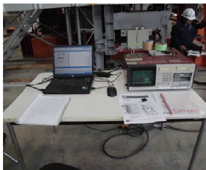
写真-2 傾斜測定機器
