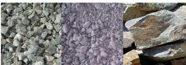
写真-2 裏込石および間詰石 (左から単粒度砕石, 粒度調整砕石, 割栗石)
