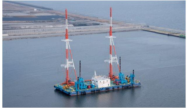
写真-2 専用のPBD打設船「VCD-Triton」
