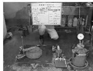
写真6 45AMフレッシュ試験状況
