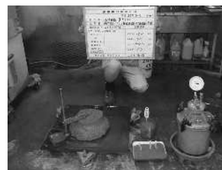
写真8 38AMフレッシュ試験状況
