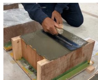
写真－3 押さえ実施状況(スラブ模擬試験体)
