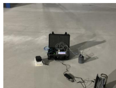
写真-5 透気試験実施状況
