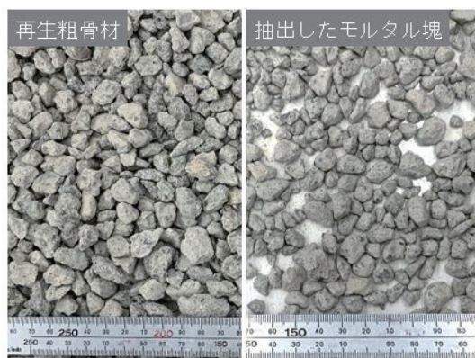
写真-2 再生粗骨材と抽出したモルタル塊
