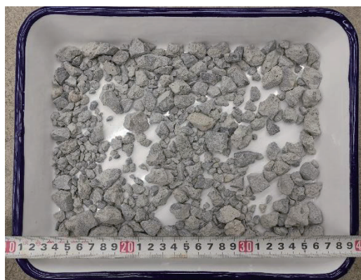
写真-1 再生粗骨材の保管状況
