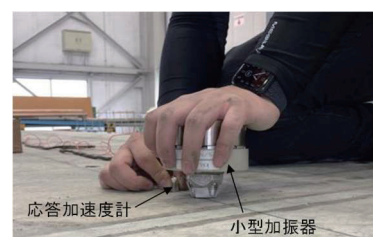
写真－3 強制振動試験の計測状況
