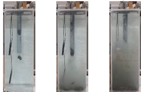
図-12 カルシア改質土の水槽への投入と濁りの発生状況
