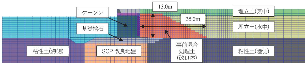
図-1 使用した FLIP 断面
