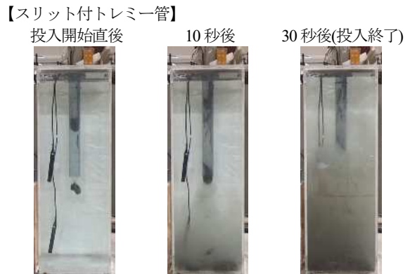
図-12 カルシア改質土の水槽への投入と濁りの発生状況
