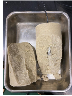
写真-1 埋め込まれた間隙水圧計
