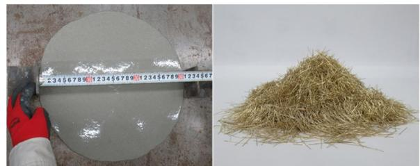
写真-1 フロー試験(左)と混入した鋼繊維(右)
