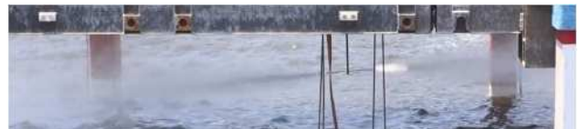
写真-2 ジェット水の噴出（海上での試行）
