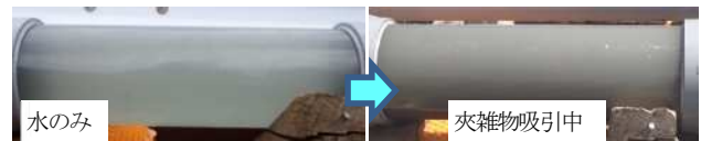
写真-3 透明管での夾雑物除去の管理
