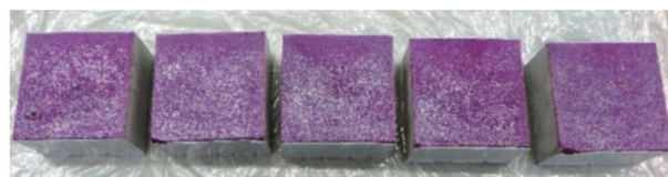
写真-4 促進中性化試験結果
