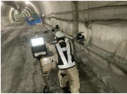
(a) 台車によるSLAM実験
