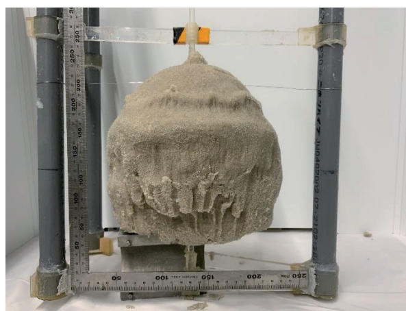
図 12 改良体出来形写真 (ケース4)
