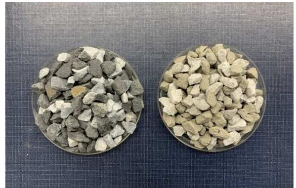
図-7 破砕後の人工石材 (左:天然石材, 右:人工石材)
